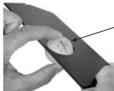
Drehen Sie den Ball in der Ballöffnung zur Überprüfung der Rundheit. Der Ball sollte in jeder Position leicht drehbar sein.
